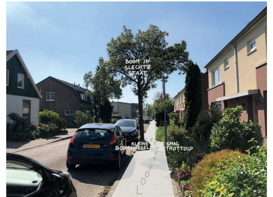
figuur 2.11: Station Velp – Astrum College, Enkele straatboom in slechte staat door kleine boomspiegel
