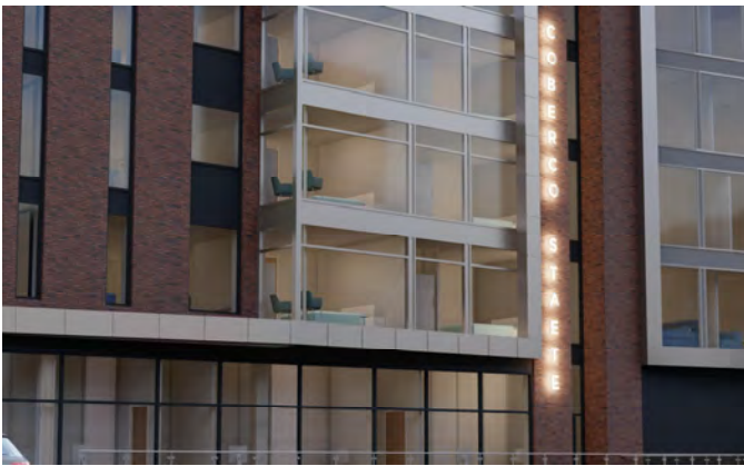
De uitkragingen zijn voorzien van een zinken kader om het robuuste karakter te versterken. (Foto: Variant 1, Wesley Sewalt)
